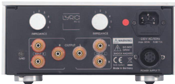
Trotz ausgelagertem Trafo sitzt die Netzbuchse – sehr ungewöhnlich – am Verstärker, damit auch der Netzschalter. Die Kabelverbindung zum Trafo besitzt praxismgerechte Länge.
